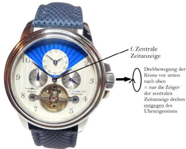
Abb. 4 Einstellen der zentralen Zeitanzeige
