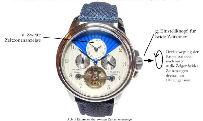
Abb. 3 Einstellen der zweiten Zeitzoneanzeige
